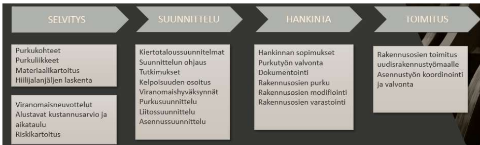
Uudelleenkäytettävien rakennusosien hyödyntämisen prosessi.
